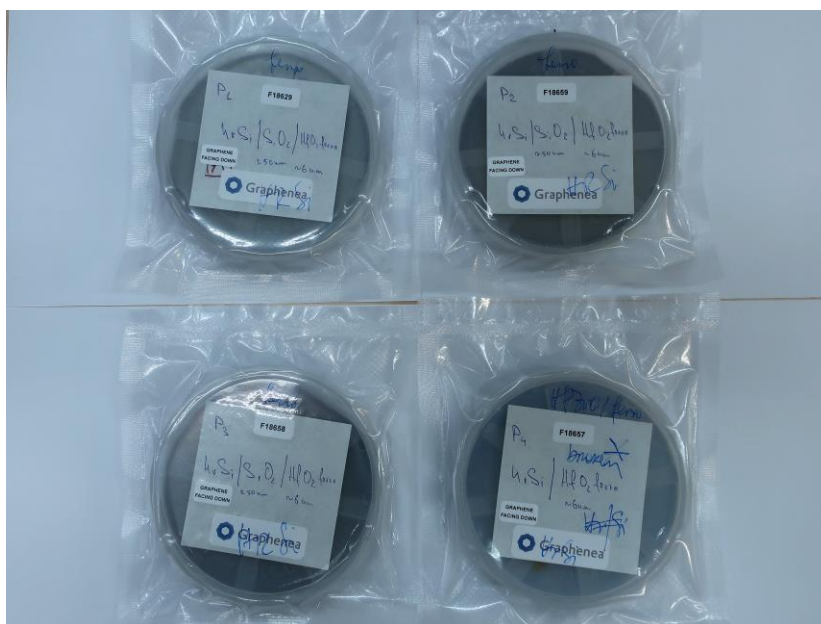
Fig. 1.1.3 plachetele de 4 inch Si/SiO 2 cu HfZrO grosime 6 nm pe care s-a transferat grafena monolayer.
